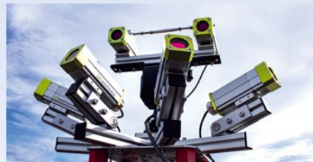
Systemmodul des Antikollisionssystems BirdRecorder für 190 Grad Halbraum mit vier statisch montierten Kameras für die Objekterkennung und einem nachgeführten Stereokamera paar für das dreidimensionale Tracking und die Artbestimmung von Vögeln (Quelle: ZSW Nico Klar).
